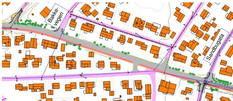
Figur 1: Viser mangelfullt overvannsnett i Vefsnvegen mellom Bakkegata og Sandbugata.
