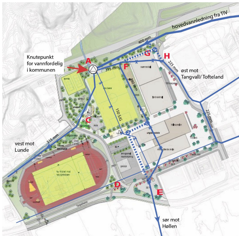
Figur 65: Skoleanlegg, vannledninger og plassert mer enn 4 meter fra dagens pumpestasjon.
