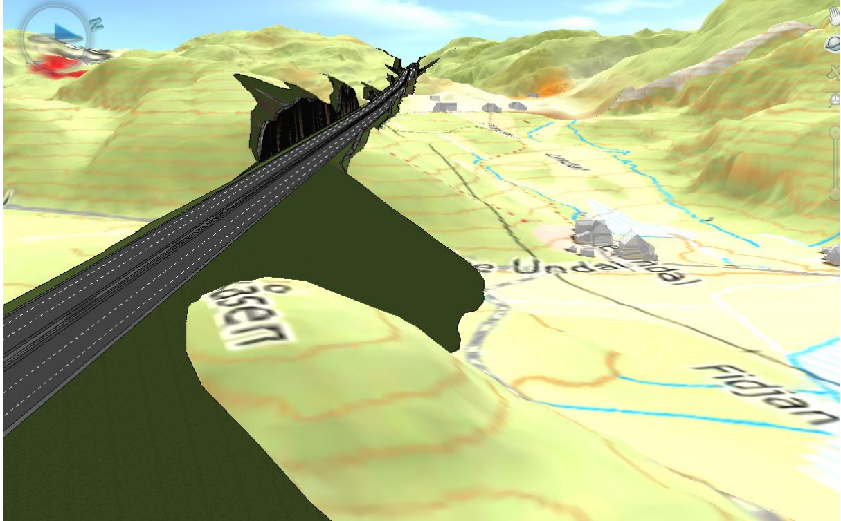
Figur 5-17 Modellbilde av alternativ AB Nord ved Nedre Undal sett mot Øvre Undal. Tiltaket ligger på tvers av landskapets småformer. Fyllingen på illustrasjonen er ca. 30 meter høy og 65 meter bred på hver side av veien.
