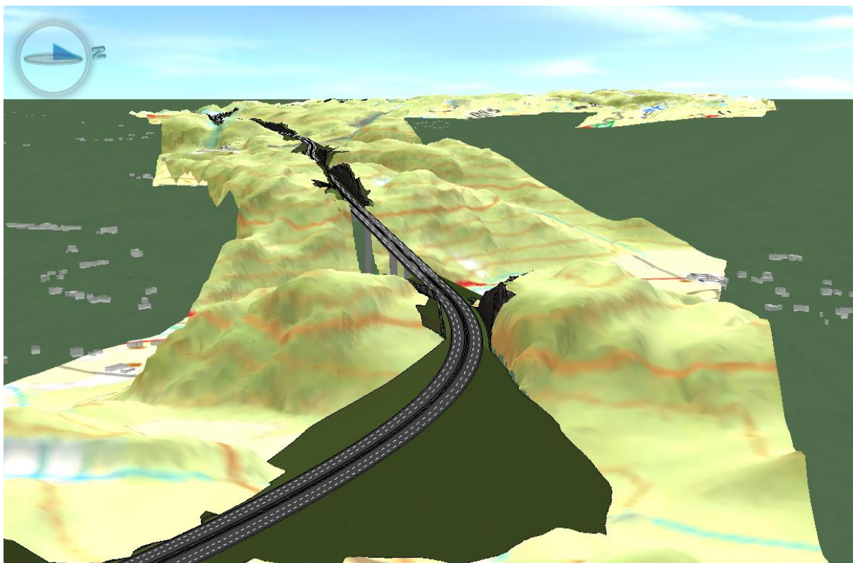
Figur 5-40 Modellbilde av titlaket sett fra Skoftedalen og vestover mot Audnedalen. Fyllingen over Skoftedalen er på illustrasjonen ca. 55 meter høy og 100 meter bred. Mellom Skoftedalen og Audnedalen er tiltaket lagt i søkket mellom de to kollene og dermed forankret i eksisterende landform
