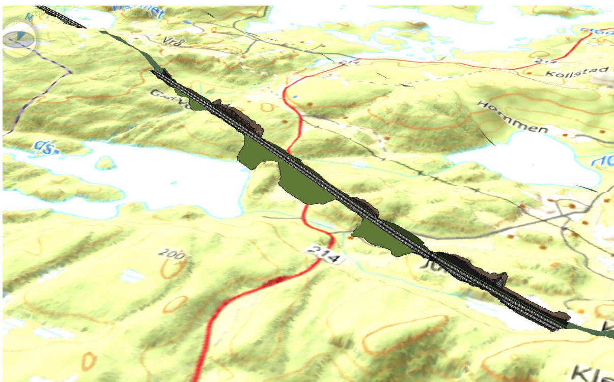
Figur 5-20 Modellbilde av titlaket ved mellom Kleivan og Vråvatnet. Ytre Lauvstøl sett mot Stigland. Tiltaket etablerer en ny terrengform som danner en visuell barriere mellom de to gårdene og Kjerr. Fyllingen ved Ommundsvatnet er på illustrasjonen ca. 40 meter høy. Skjæringen nord for Vråvatnet er ca. 25 meter høy.
