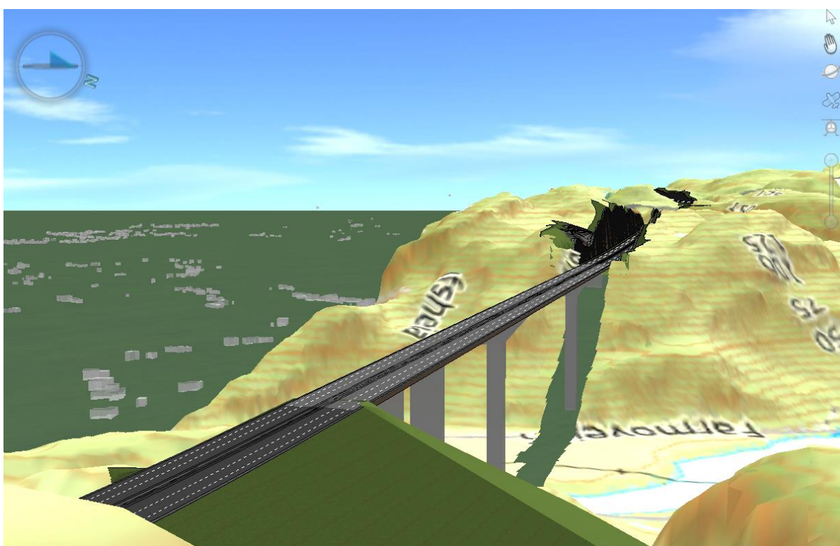
Figur 5-40 Modellbilde av titlaket sett fra Skoftedalen og vestover mot Audnedalen. Fyllingen over Skoftedalen er på illustrasjonen ca. 55 meter høy og 100 meter bred. Mellom Skoftedalen og Audnedalen er tiltaket lagt i søkket mellom de to kollene og dermed forankret i eksisterende landform
