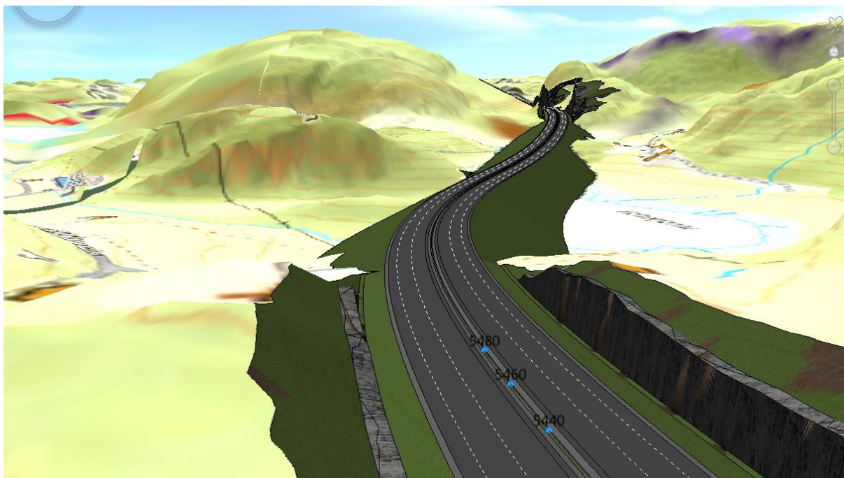
Figur 5-23 Modellbilde av titlaket sett fra Lia vestover over Holtetjønna mot Holte. Fyllingen over dalen er på illustrasjonen er ca. 15 meter høy på det laveste.
