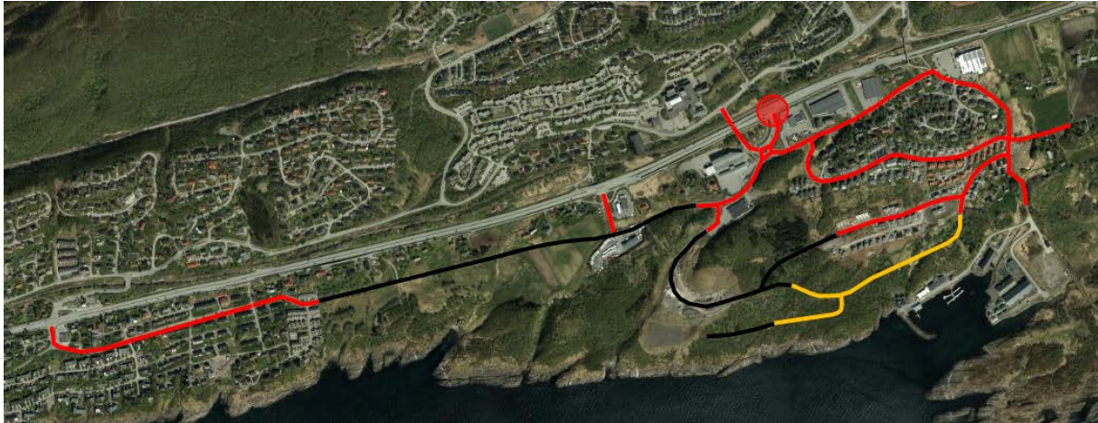
Figur 49: Illustrasjonen viser eksisterende kjøreveier i området i rødt, regulerte veier i gult, veier fra planforslaget i sort. Kryss mot RV80 markert med sirkel.
