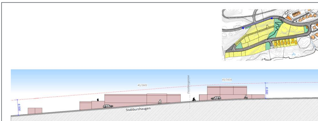
Figur 5. Illustrasjon/oppriss som viser forslag til høydebegrensning for felt B22
