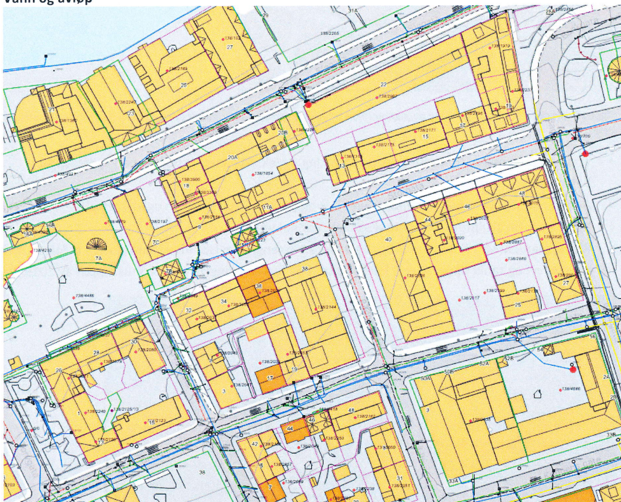
Figur 19: Blå ledninger er vannledninger, rød er avløp og grønn er spillvannsledning. Vann og -avløpsledninger i Storgata er gamle og må skiftes ut.
