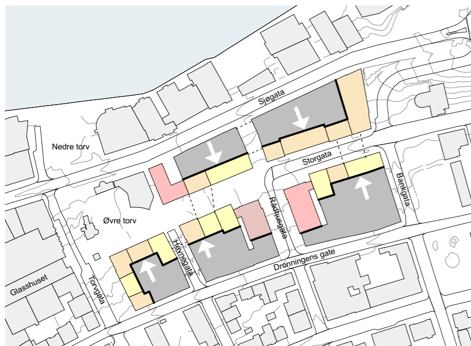
Prinsipiell plan på nedre nivå mot gate. Ny bebyggelse kan bygges mot klassifisert bebyggelse fra bakgård. Utendørs trasè mellom kvartalene har takoverbygg.
