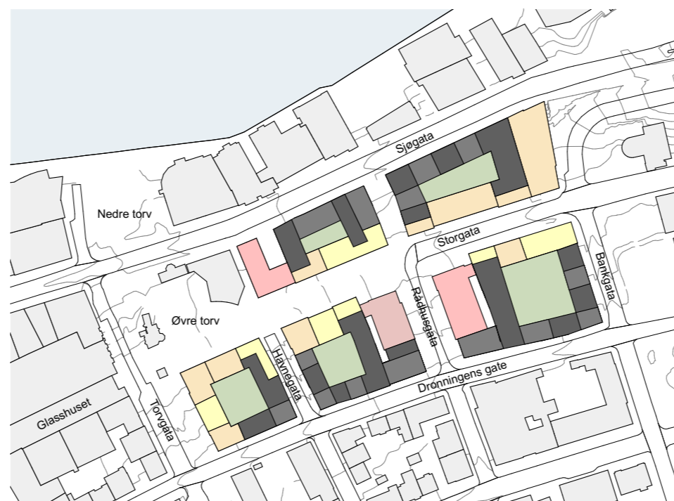
Prinsipiell takplan. Boligbebyggelse på øvre nivå kan få gode felles uteoppholdsareal på tak til bebyggelsen på nedre nivå (markert med grønt).
