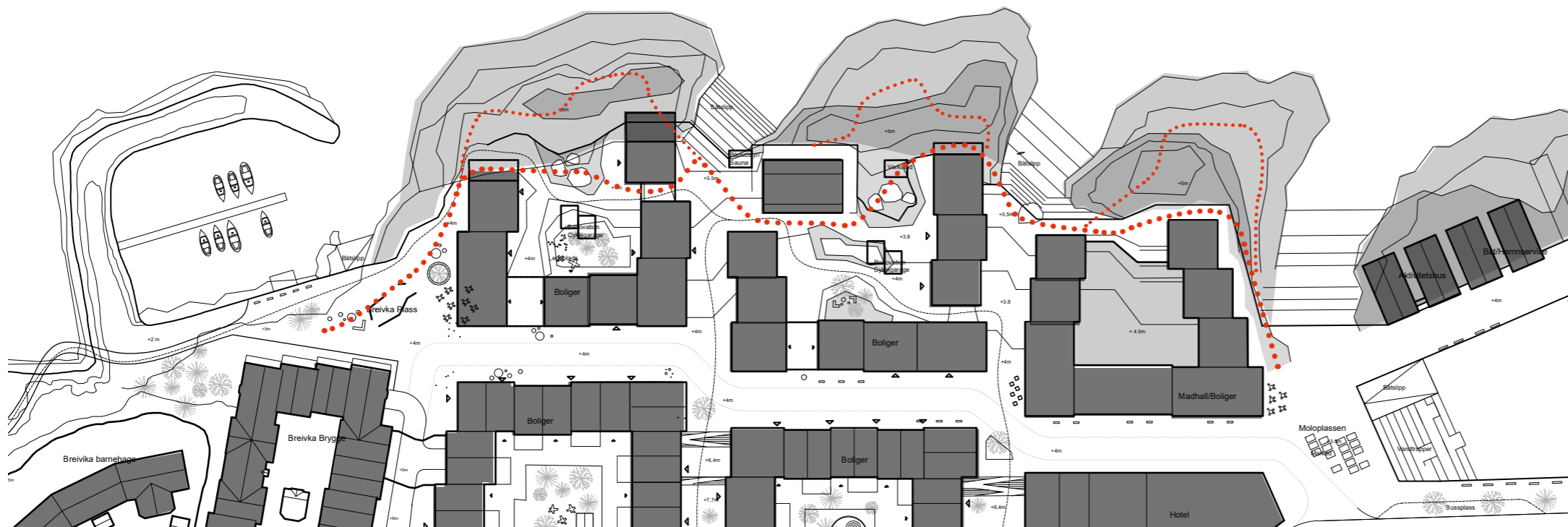
Lavvande -1.98m NN2000 - Der er omtrent 7m. mere synlig stenudfyldning ved lavvande
