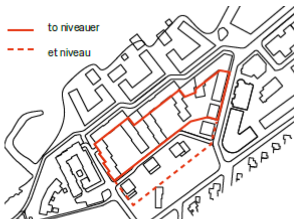
Figur 92- Etablering av garasjeanlegg under bakken.
