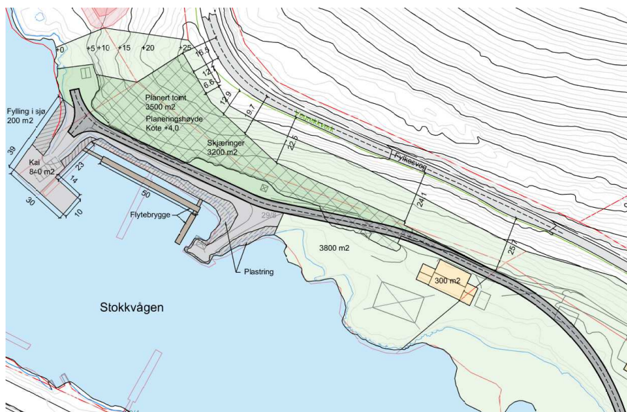
Figur 5. Oversikt over planlagt grunnarbeid (Prodeco 2017)
