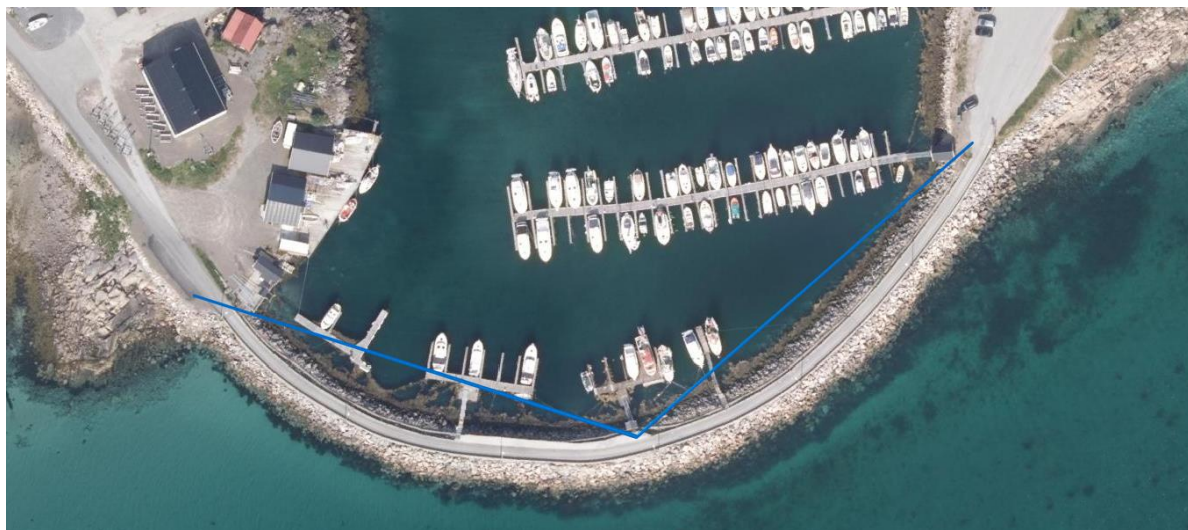
Figur 22: Viktig med sikt til motgående trafikk mellom blå linjer for at møteplassene skal fungere som tiltenkt.
