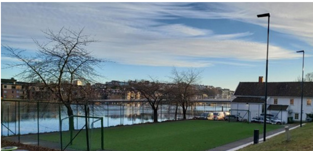
Belysning av balløkke. Armaturer plasseres fortrinnsvis slik, ved langsiden. Elveparken ved Kvadraturen.
