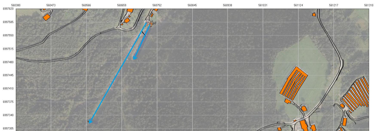
Figur 2-1: Skisse av plassering av rifleskytebanen med avstand til skyteskivene på 300m og 100m
