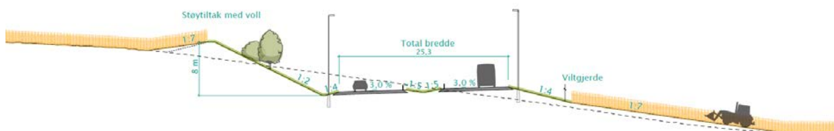
Figur 7-17: Mellom nordre tunnelportal og krysset på Losen ligger vegen i en skjæring mellom to terrasser. Terrassedelingen forsterkes ved å legge skråningen i 1:2 og forme skjæringen som en naturlig brink. Vegetasjonen skal få etablere seg. Skråningen bygges med en overhøyde slik at den også får en støyskjermende funksjon. Det er en intensjon at det skal kunne dyrkes på begge sider av E6 på utsiden av viltgjerdene. Terrenget legges med helning 1:7 her.
