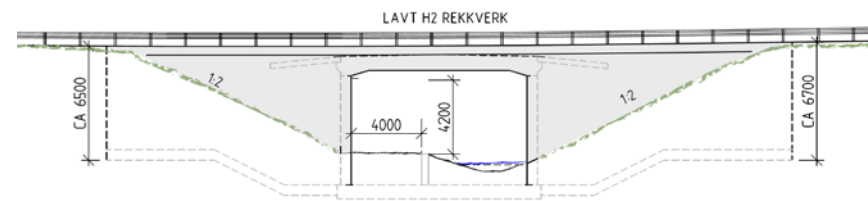
Snitt av Kulvert for ny bekkekryssing for Loa, turveg og driftsundergang. (Ill: Marianne F. Larsen)
