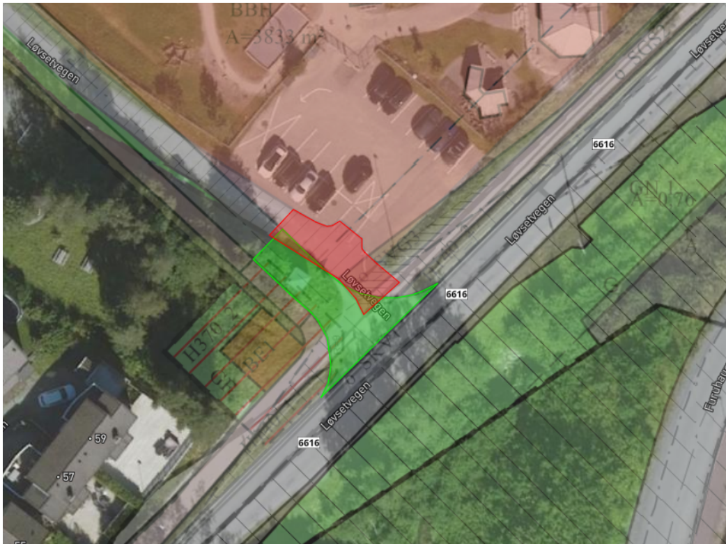
Figur 3: Rød figur illustrerer gammel kryssløsning, grønn illustrerer nytt kryss
