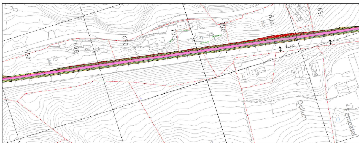
Figur 13 Vegtegning profil 550-850 – Fjellskjæring
