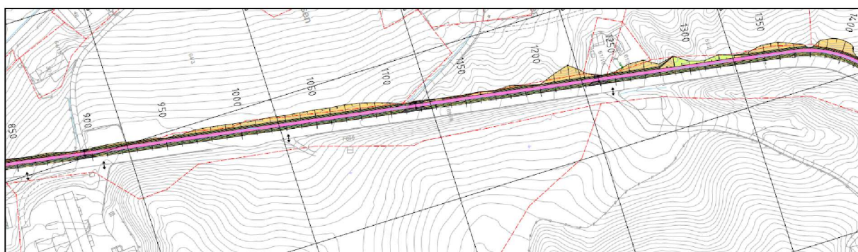
Figur 14 Vegtegning profil 850-1450 - Jordskjæring
