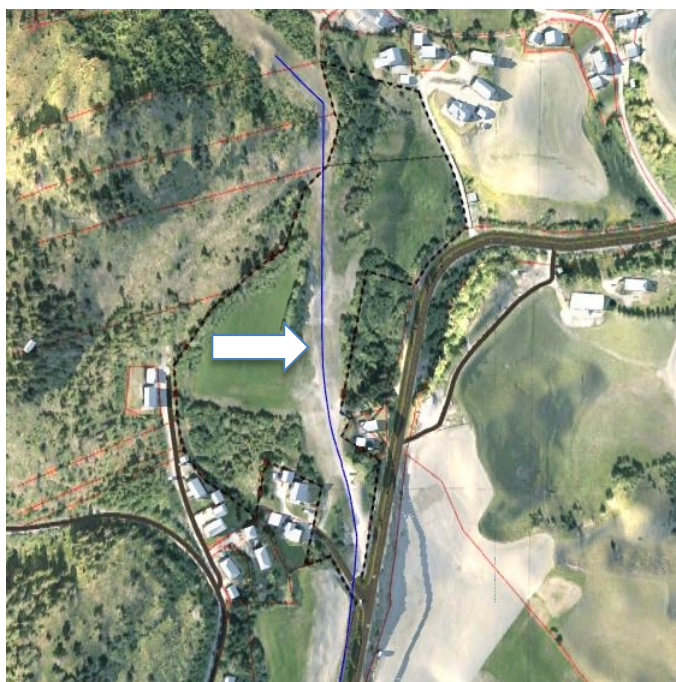
Figur 2-13. Utsnitt av terrengmodell med trasé (i blå) for hovedvannledning.
