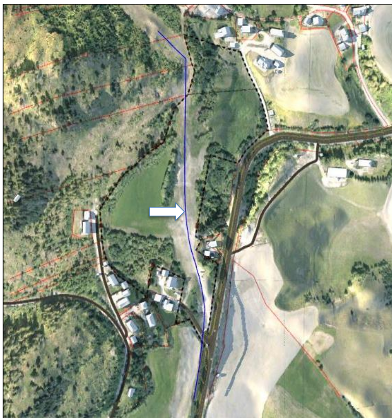
Figur 3-2. Utsnitt av terrengmodell med trasé (i blå) for hovedvannledning.
