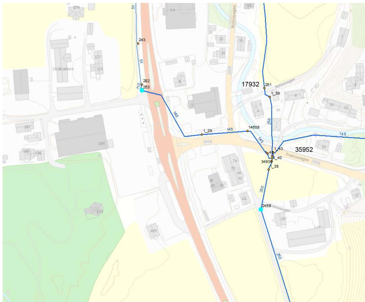
Figur 1 Utsnitt av Melhus vannforsyningsnett ved Ler med indre diameter på ledninger og aktuelle kummer markert i lyseblå.
