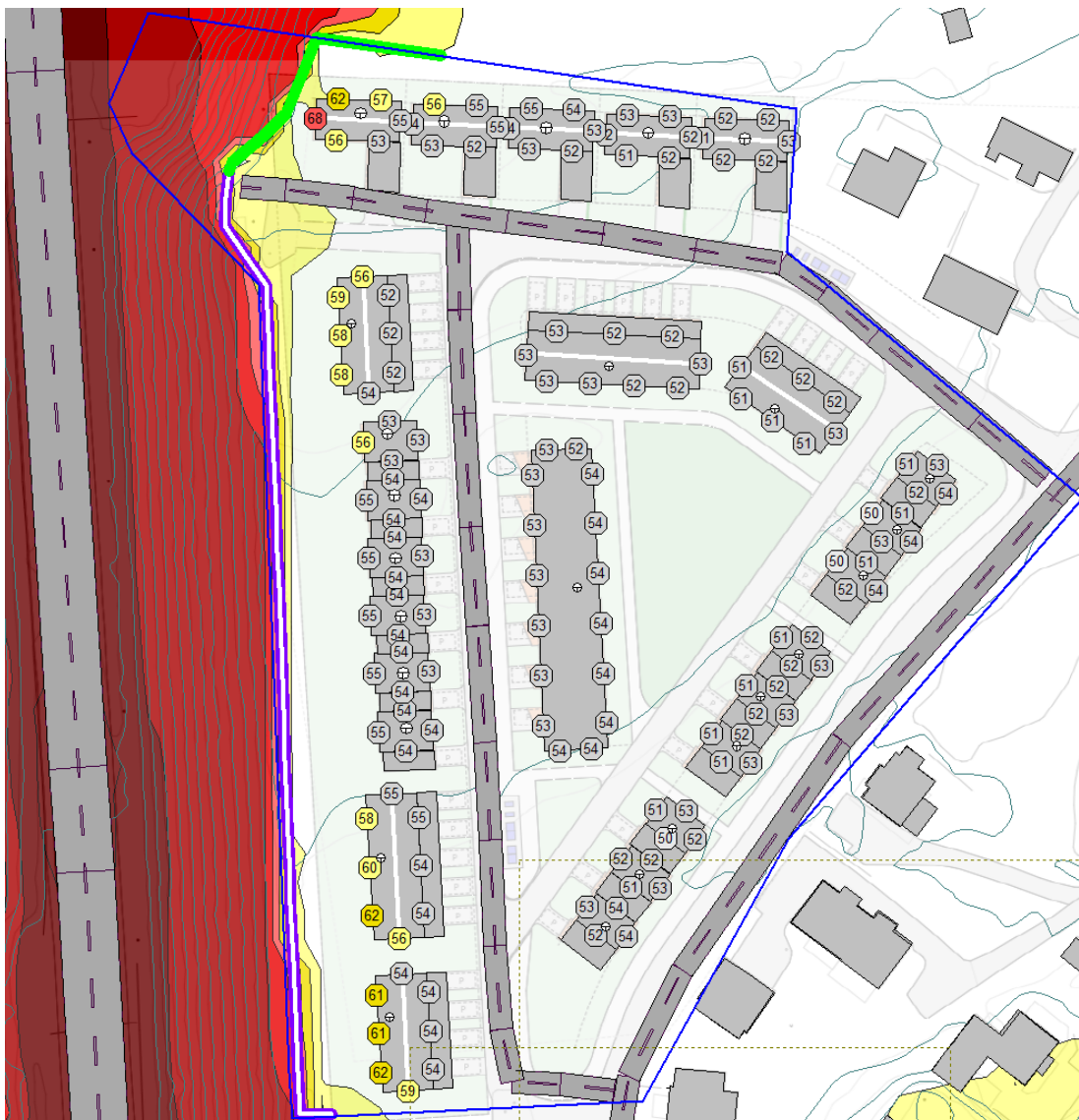
Figur 6: Beregningsresultat med skjerm løsning langs E6 i vest som vist i figur 5 og med 3 meter høy støyskjerm langs jernbanespor i øst (alternativ 2). Støysoner er vist i 1,5 m høyde, fasadenivåer er høyest nivå på fasade uavhengig av etasje.
