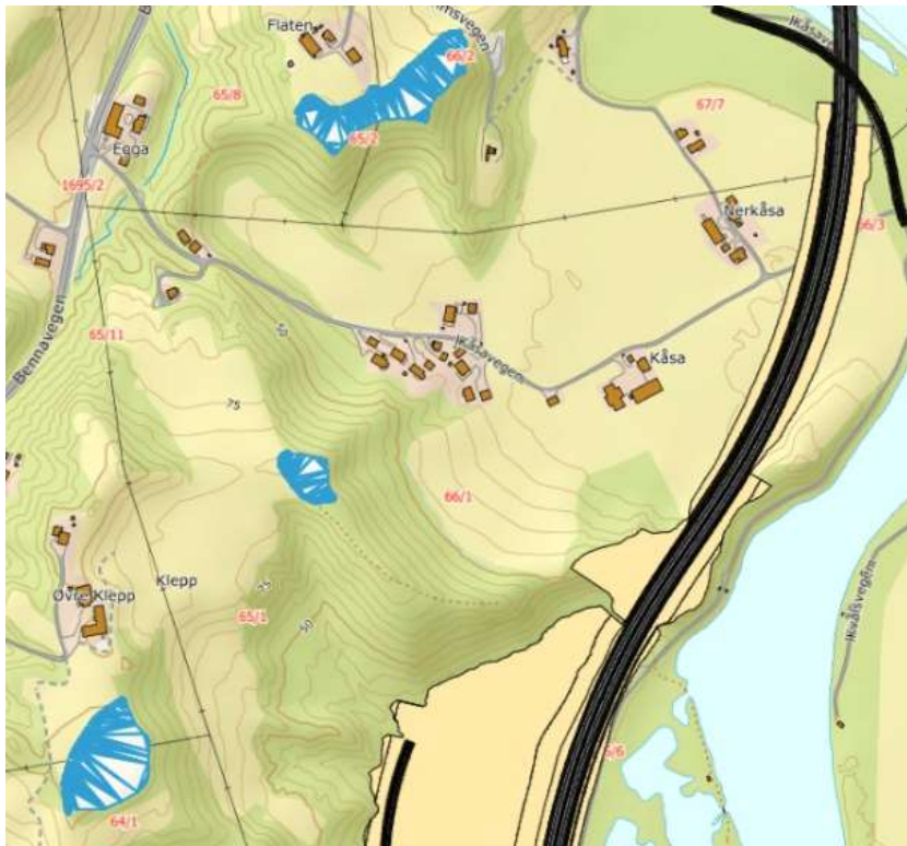
Figur 4-14 Områder der masser fjernes for å bedre områdets stabilitet er markert med blå skravur (Kilde Norconsult).
