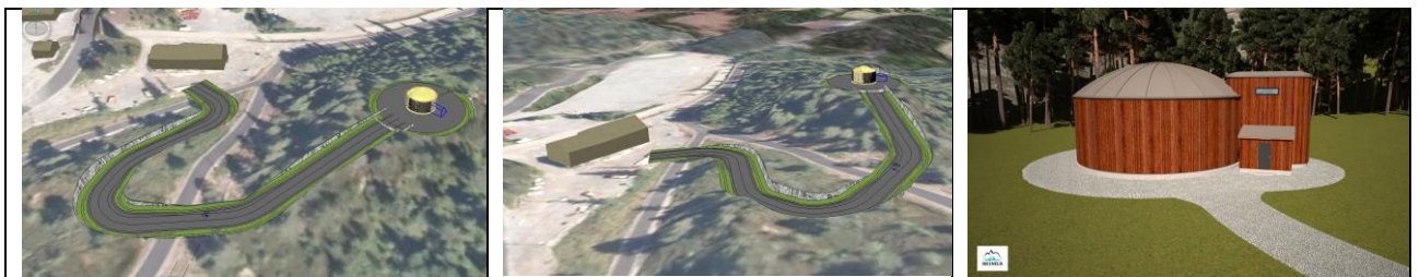
Figur 8 Illustrasjon til venstre: veg og høydebasseng sett fra sør, i midten: veg og høydebasseng sett fra vest, til høyre: illustrasjonsbilde av høydebasseng med trapperom og ventilkammer.
